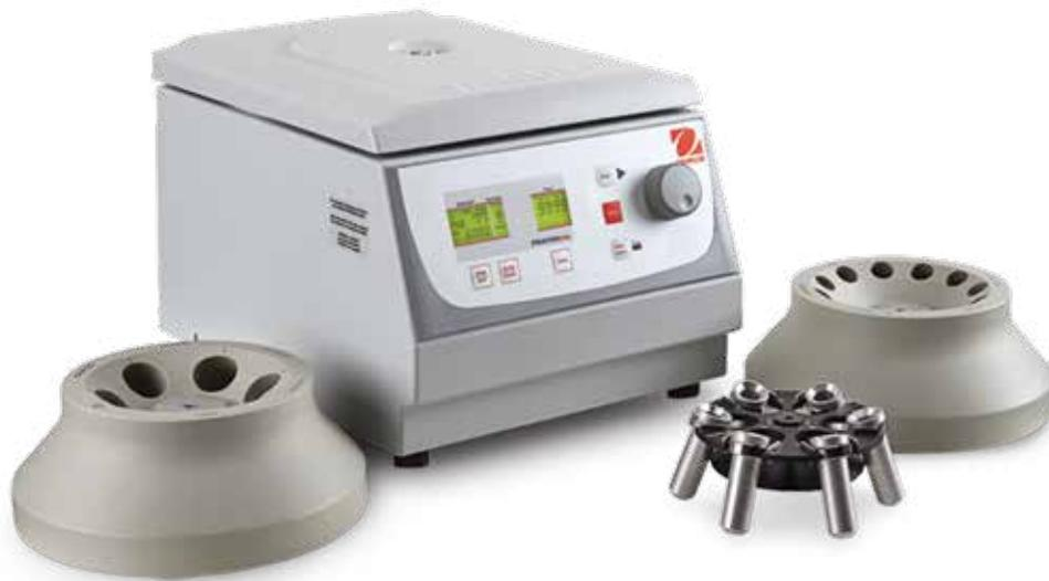
***Rotores y adaptadores que amplían la versatilidad de la Centrífuga Frontier FC5706***
