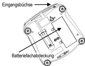
Verbinden Sie den Netzstecker mit der Eingangsbuchse.
